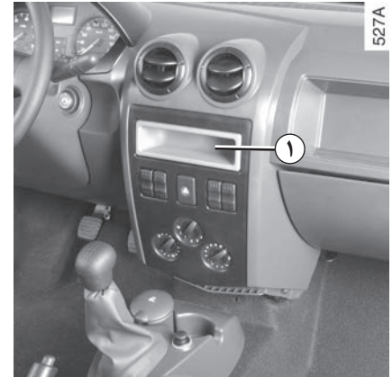
۱ محل نصب سیستم صوتی درپوش را بردارید. اتصالات آنتن، تغذیه + و - ، سیم‌های بلندگو چپ و راست در پشت آن قرار دارند.
